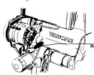
Cooling water drain cock Robinet d'evacuation de l'eau de refroidissement
